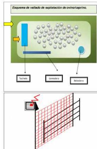
Figura 1: Esquema del sistema de protección del rebaño de ovino/caprino en explotación con sistema de doble vallado: vallado inicial de la explotación rodeado del sistema de malla o cable electrificado.
